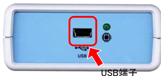
USB-DI(G) Bluetoothユニット側面図
