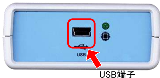
USB-DI(G) Bluetoothユニット側面図
