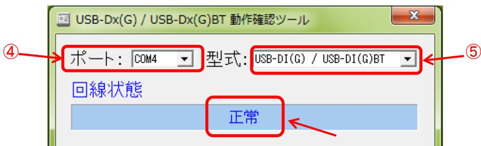
回線状態に「接続断」と表示された場合は、ユニットとの接続を確認してください。
