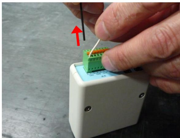
(4) ワイヤを抜くときは、細い棒を出力コネクタのノブに押し込んでワイヤを引っ張ると抜けます。
