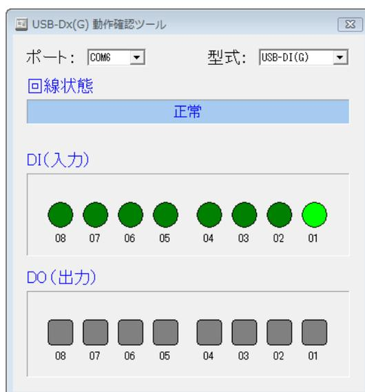
⑧ DO(出力)の■をクリックすると、指定したbitの出力ON/OFFが切り替わります。
