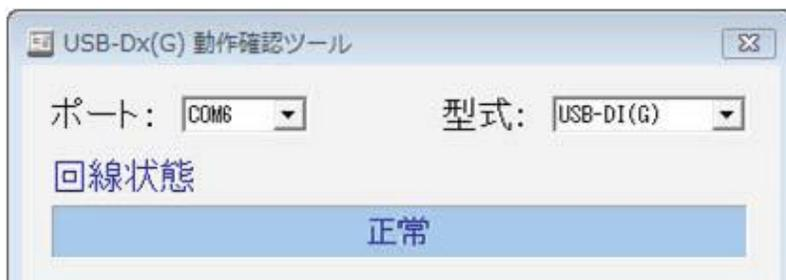
回線状態に「接続断」と表示された場合は、ユニットとの接続を確認してください。
